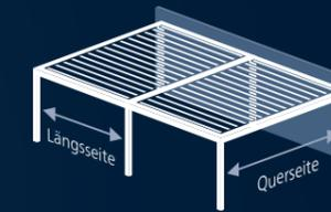
**Kopplung in Längsrichtung**
